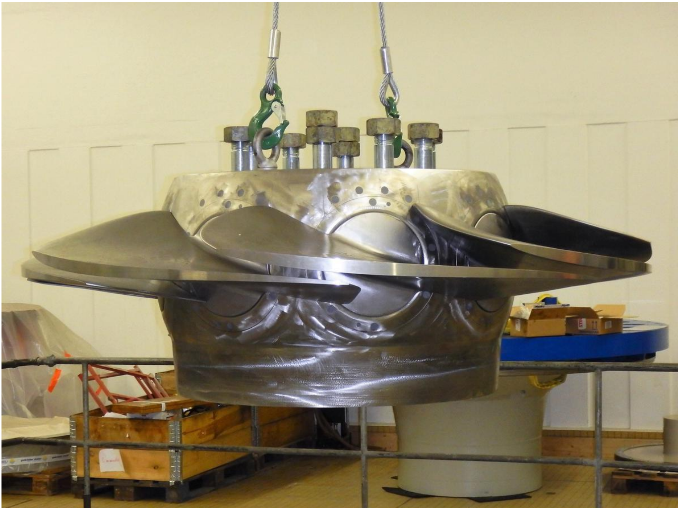
Das Laufrad der Kaplanmaschine «verarbeitet» pro Sekunde 22 Tonnen Wasser. Foto: Guido Lauper
